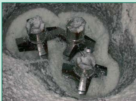
Figure 3. Pulpeur EMI à 3 arbres avec disques de différents diamètres.
