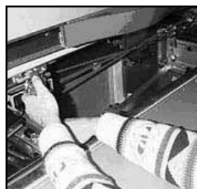
Un système de courroies - en rouge - assure le retournement de la feuille pour l'impression au verso.
