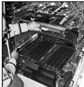
Le module de pré-conditionnement : pour stabiliser la feuille dès le début du process.
