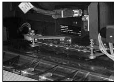
Contrôle permanent de la chromie au moyen de trois diodes RVB.
